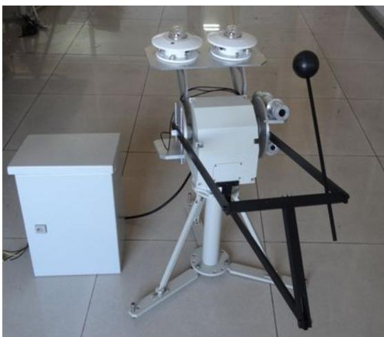
全自动太阳辐射测量设备（220v 供电型）
