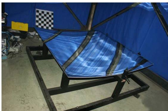
槽式曲面玻璃镜面形测试设备主要用于测量槽式太阳能聚光器曲面玻璃镜的面形误差，是评估曲面玻璃镜面形质量和聚光性能的必备装置。随着我国太阳能光热
